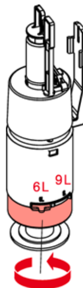
Ablaufventil A1, Spülmengeneinstellung
