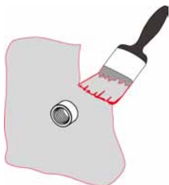
Fig. 1: Stendere alla base una mano di sigillante
