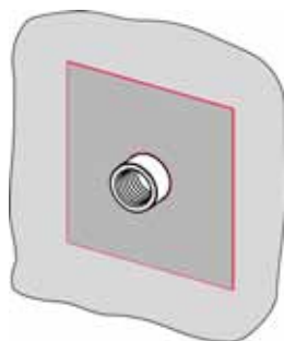
Fig. 2: Mentre il sigillante è ancora umido applicare la rosetta di tenuta.
