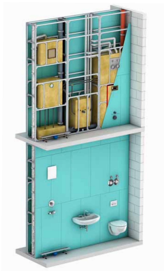
F 90 in parete con spessore 286 mm
