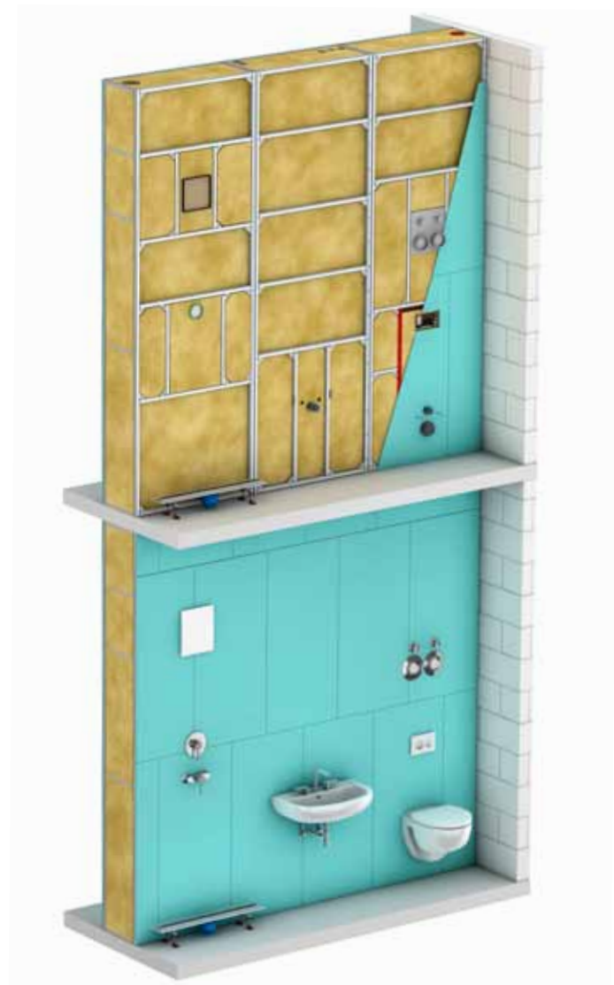
F 90 in parete con spessore 386 mm
