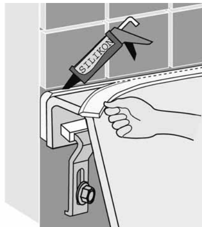
Isolamento con il nastro isolante ed il silicone.
