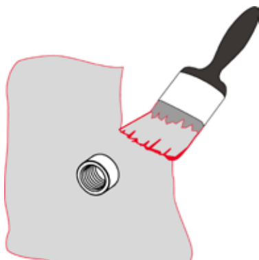
Fig. 3: stendere un'altro strato di vernice sigillante.
