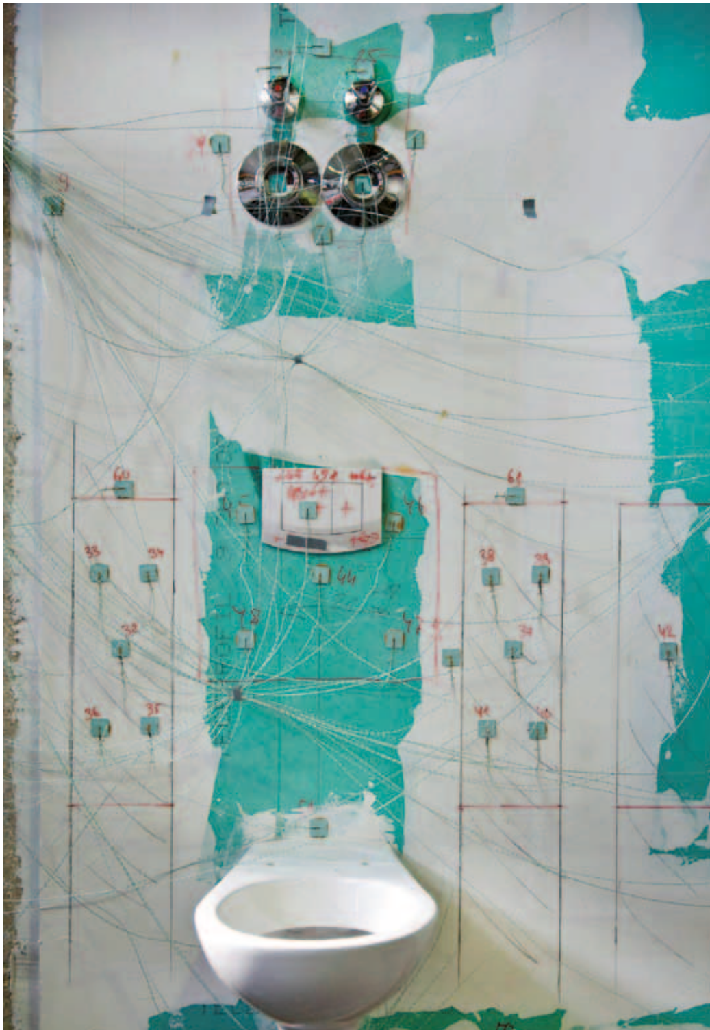
Abb. oben: Anlage zur Schallpegel- messung beim Fraunhofer Institut Stuttgart.
