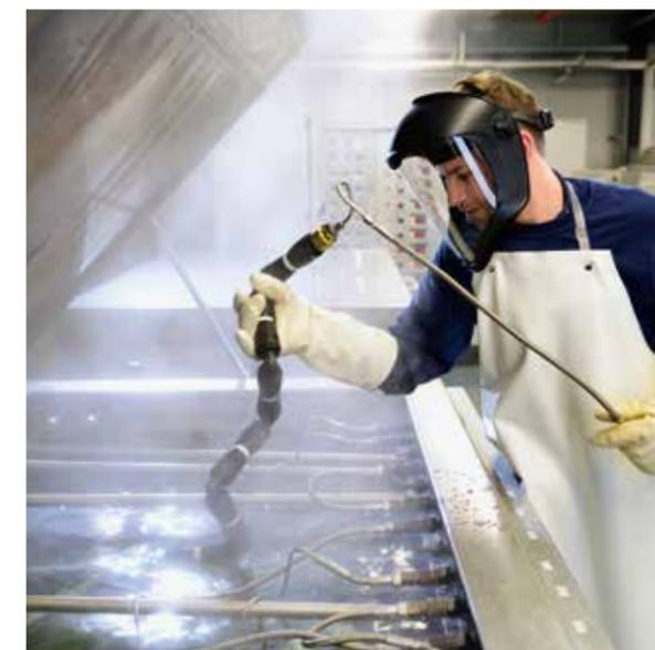
Ein Prüfbaum mit einer Vielzahl von Verbindungsstellen wird im Wasserbad bei 90°C und 10 bar auf Dichtheit geprüft. Bei einer Undichtigkeit kann schnell das ursächliche Bauteil identifiziert werden. Über die Chargenverfolgung können alle produzierten Teile zur weiteren Kontrolle ausgeschleust werden.
