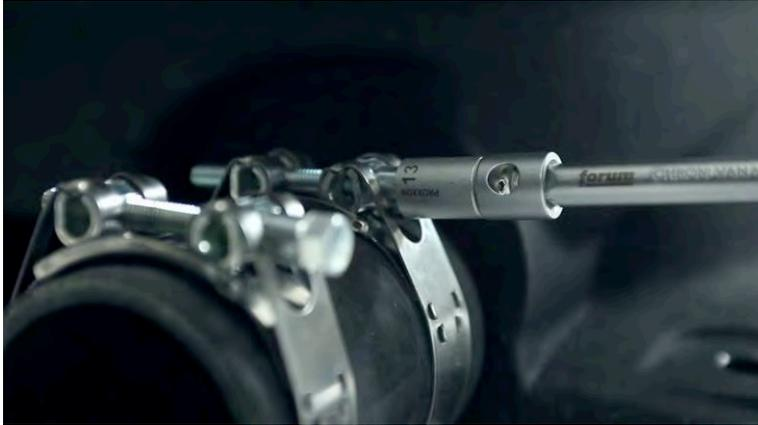
6. Gelenkbolzenschelle am Behälter anschrauben und festziehen (13er Schlüssel)
