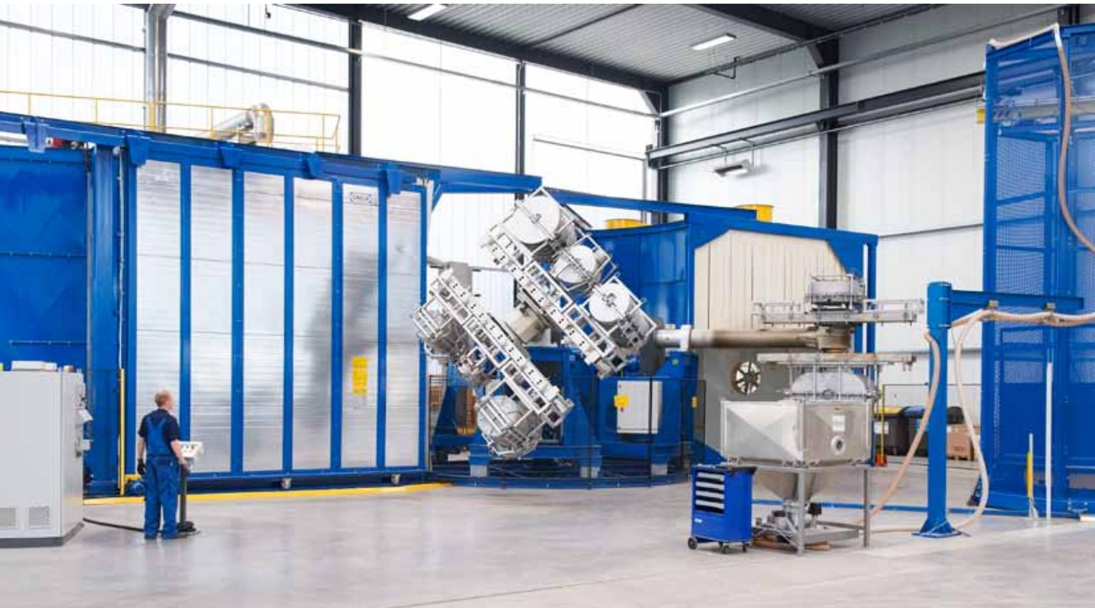
TECEsepa Fettabscheider werden in den TECE-eigenen Standorten in Deutschland produziert. So kann die gleichbleibend hohe Qualität der Bauteile und eine ständige Verfügbarkeit unabhängig von externen Lieferanten garantiert werden. (Bild: TECEsepa Rotationsanlage in Emsdetten)
