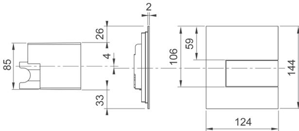
Urinalbetätigungsplatte und Rohbauschutz für vertikale Fugenausrichtung
