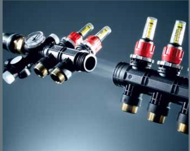
Die Zweifach- und Dreifach-Kunststoffverteiler von TECE können mit zwei Umdrehungen einfach verbunden und beliebig kombiniert werden – bis hin zu einem Zwölfach-Verteiler. Das vereinfacht die Lagerhaltung und erhöht die Flexibilität auf der Baustelle: Ist ein zusätzlicher Heizkreis gefordert, werden statt eines Dreifach-Moduls einfach zwei Zweifach-Module verwendet.
