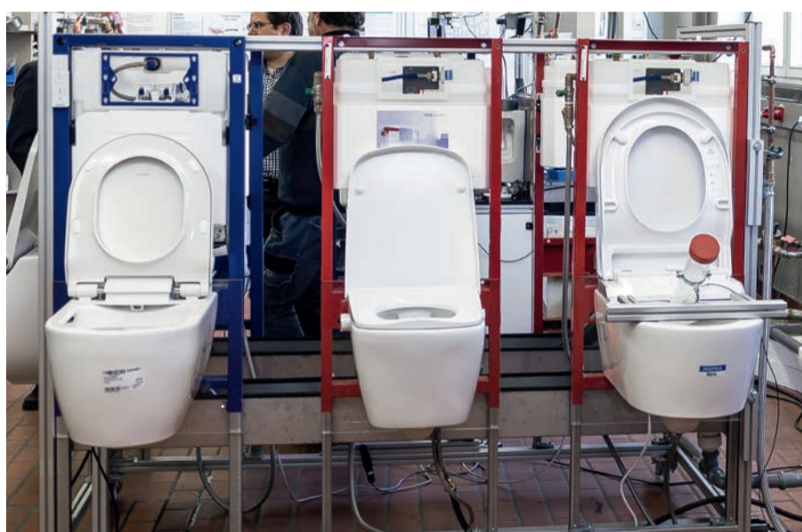
3 Reinigungsleistung getestet: TECEone im Test. Das Plexiglas-Lochraster wird mit normgerechtem, mittelscharfem Senf bestrichen – dann erfolgt die Reinigung.
